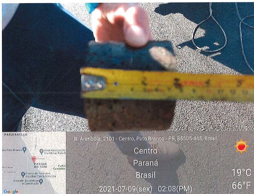
Foto 06: Extração corpo-de-prova Rua Urbano Wittmann
