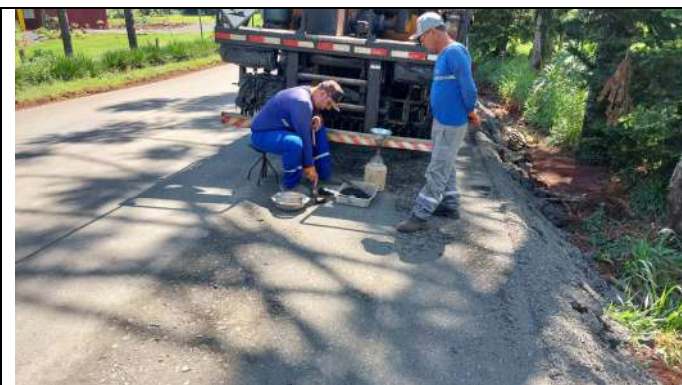
FOTO 06: ENSAIO BASE DE BRITA GRADUADA
